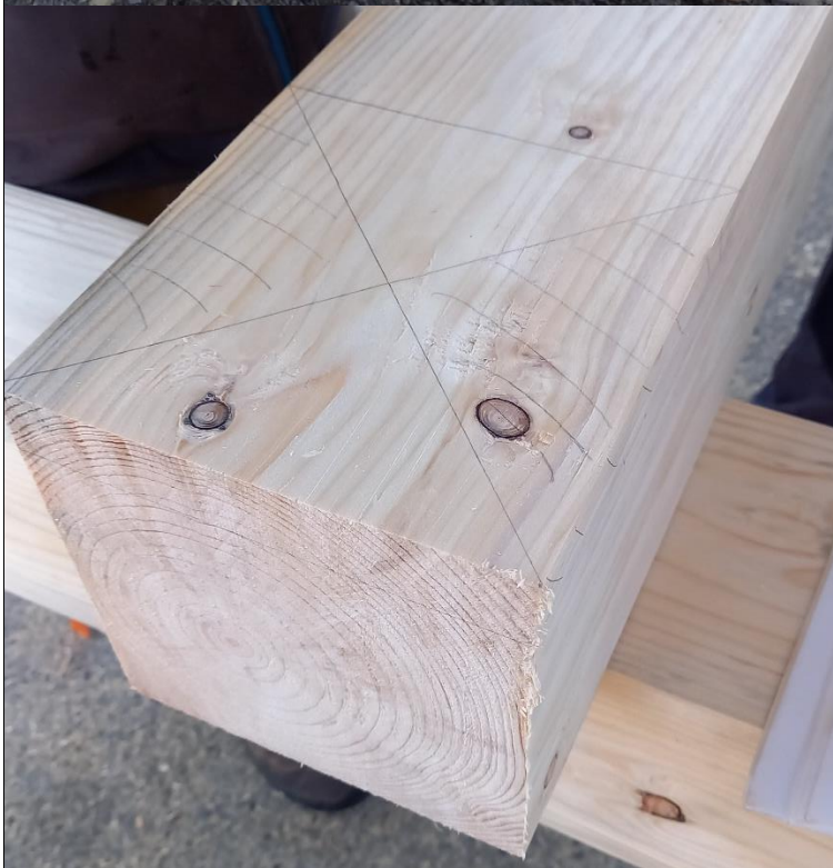
Varianta spoje, vhodný např. k připevnění stojen k základovému lemu. Vhodné doprostřed trámu. Na rohu je spoj nebezpečný, protože může dojít k odtržení rybiny.
